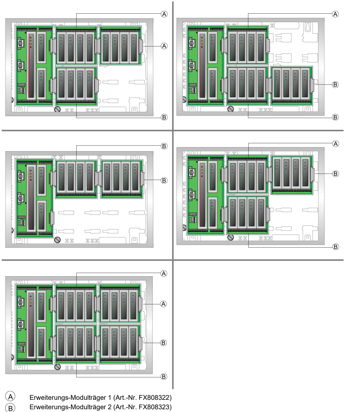
Abb. 10: Einbaubeispiele der Erweiterungs-Modulträger (waagerechter Einbau mit Rückwand Art.-Nr. FX808310)
